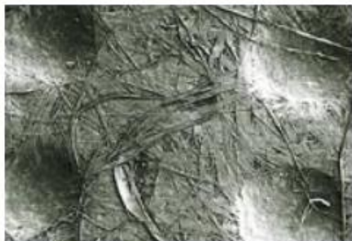
Структура материала Тайвек® (увеличение в 50 раз)
